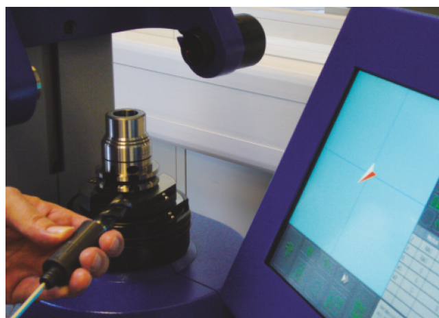
2. Шаг: Зажим инструмента с использованием оптической системы измерения вылета инструмента.
