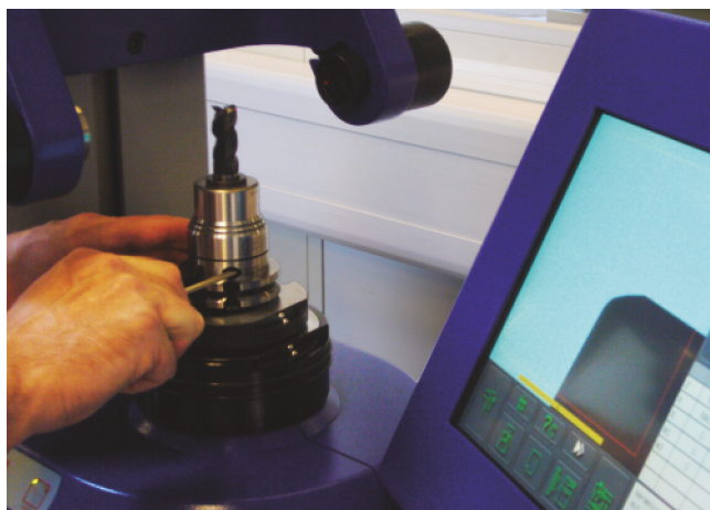
3. Шаг: Разжать патрон и отрегулировать вылет упора с учётом полученной погрешности на втором шаге. Один поворот ключа равен 1,25 мм изменения вылета упора.
