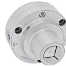
Патроны с зажимной цангой спроектированы для цанг 5С. Предназначены для токарных, шлифовальных и фрезерных работ. Приводимая в движение ключом спираль позволяет равномерно без деформации закреплять обрабатываемую деталь и быстро заменять цанги.
