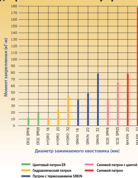
Сравнение момента закрепления для различных зажимных устройств
