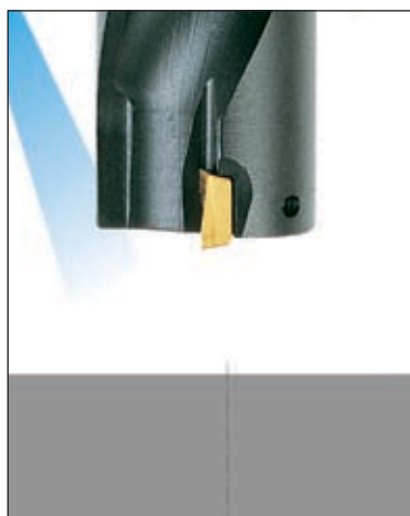
Внешнее охлаждение Глубина сверления ограничена 1.5xD. Для больших глубин - цикл с периодическим выводом сверла.
