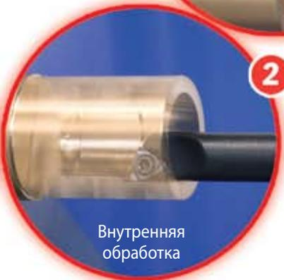
**Многофункциональный инструмент для сверления, расточки, торцевого и наружного точения**
