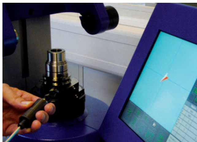
2. Шаг: Зажим инструмента с использованием оптической системы измерения вылета инструмента.
