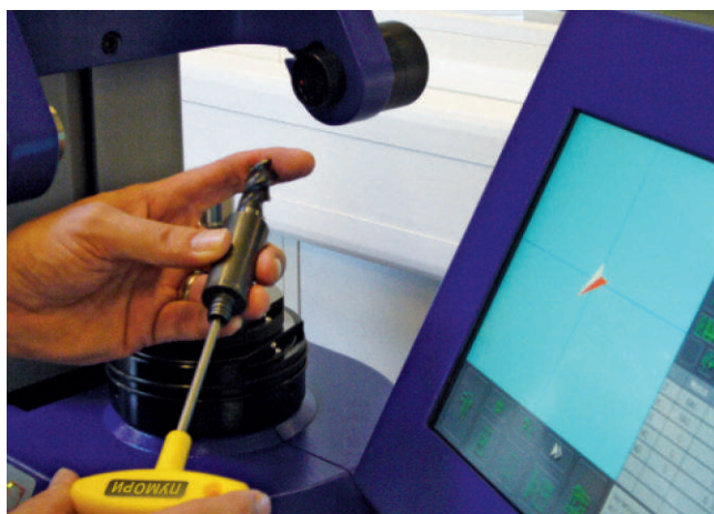
1. Шаг: Предварительная регулировка упора цанги.
