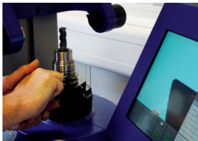
4. Шаг: Затянуть патрон снова. Величина момента затяжки от 10 до 14 Нм является достаточной для надёжного закрепления инструмента.
