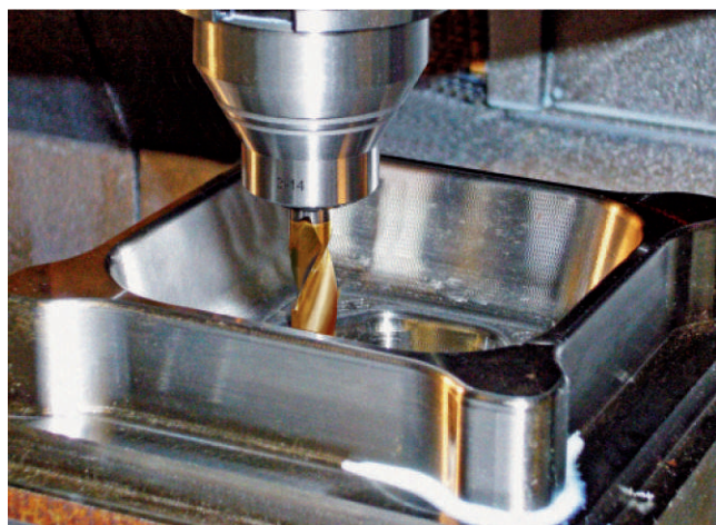
Короткий вылет и малый диаметр B240...14 Ø 3 - 14 мм
