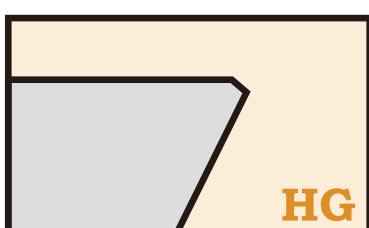
**HG** - Режущая кромка с отрицательным углом для получения фасок.
