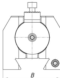
\* Винт SB6x16 (M6x16) по DIN 912 или ГОСТ 11738.
