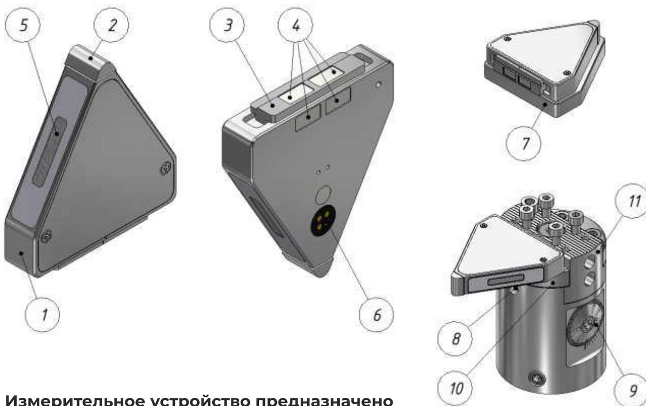
**Измерительное устройство предназначено для более точной настройки размера обработки, при выполнении расточных операций, непосредственно на станке.**
