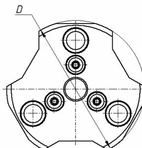
При работе необходимо учитывать наружный диаметр обрабатываемой детали
