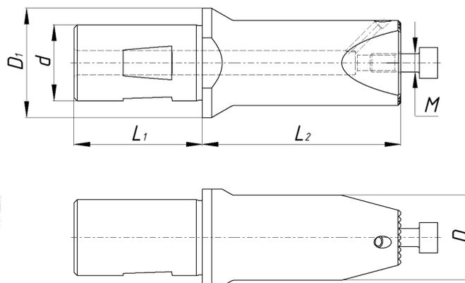
\* Винт SB6x16 (M6x16) по DIN 912 или ГОСТ 11738
