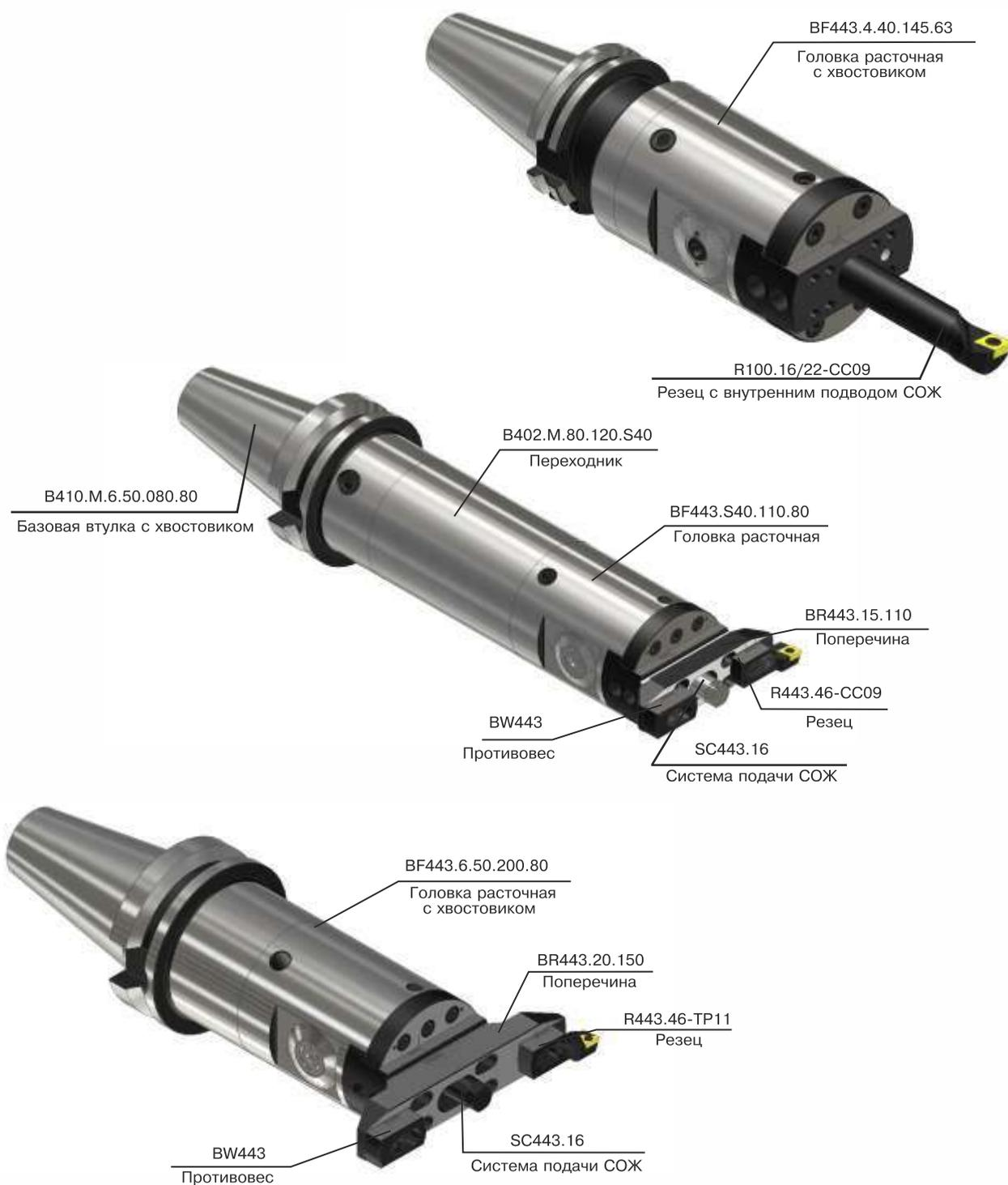
Расточные головки BF443 диаметром  $\varnothing 40$ ,  $\varnothing 50$ ,  $\varnothing 63$ ,  $\varnothing 80$  мм с диапазонами растачивания 6...74 мм, 6...126 мм, 6...168 мм, 6...290 мм соответственно. Головки комплектуются оправками и осевыми резцами с цилиндрической посадкой  $\varnothing 16$  мм с внутренним подводом СОЖ, резцами и поперечинами, что обеспечивает широкий диапазон обработки.
